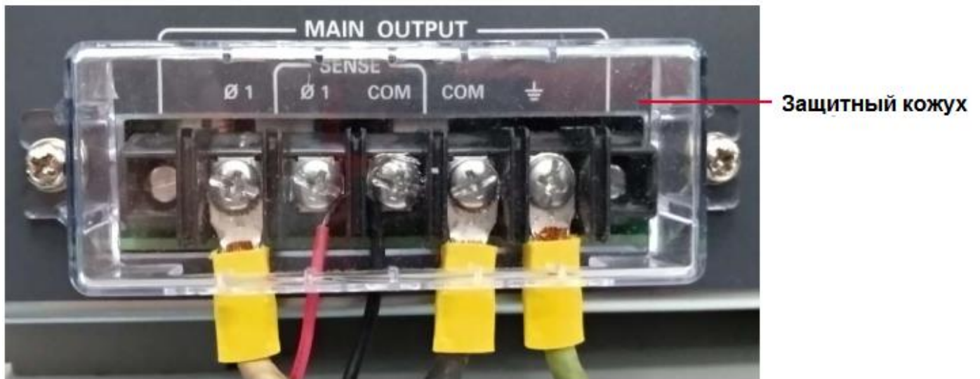
Рисунок 2-5 Защитный кожух, установленный на выходном клеммном блоке
